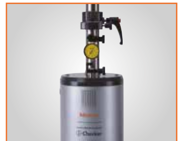
Hoobindikaatori (horisontaalne tüüp) kalibreerimine lisakomplektiga
