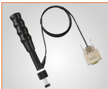
HLD + 15 löögiseade UD-413 Kasutage nõgusate detailide korral, nagu hammasrattad, kuullaagrid jne.
