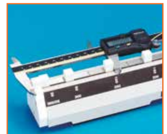
Nihiku täpsuse kontrollimine (välimine mõõtmine)
