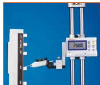
Kõrgusmöödiku täpsuse kontrollimine
