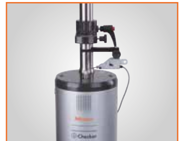
Hoobindikaatori (induktiivne möödik) kontroll
